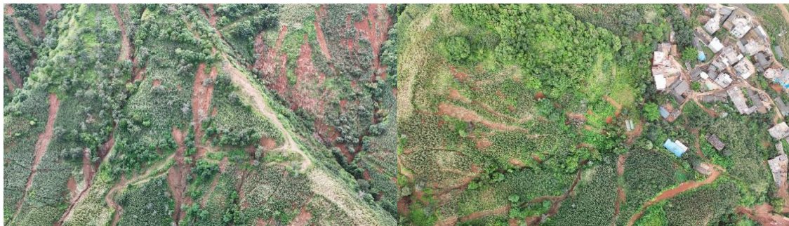
图 5.5-1 大麦地村 N4 泥石流物源区坡面侵蚀
